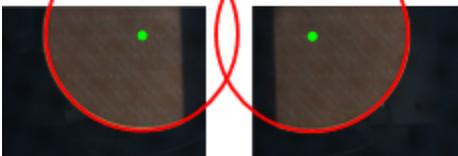
チップサイズが小さくなった事で、印字されているBADマーク自体のサイズも小さくなり、1視野撮像でのレンズ倍率では、検査が困難。
