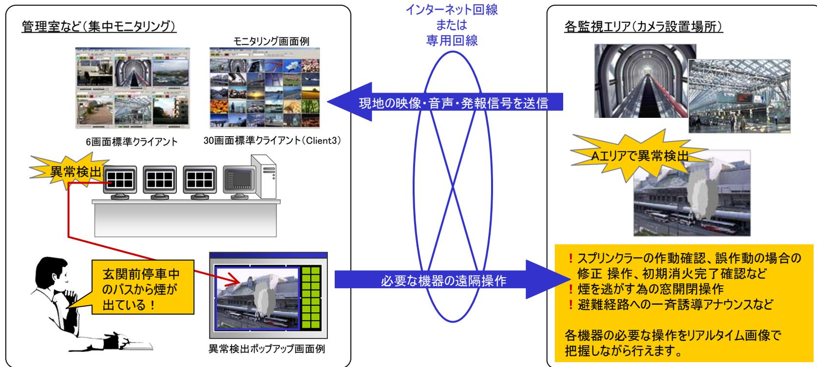
各種センサーを設定した箇所では異常を検出すると、警報を鳴らし、異常個所の映像をポップアップ画面で瞬時に表示します。異常個所、または全体の様子を映像で確認しながら、必要な機器の操作(初期対応)をそのまま遠隔地から行えます。
